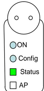
Die Anzeige AP geht aus und zeigt damit die gesicherte Verbindung an. Die Status Anzeige wechselt und zeigt die Verbindungsqualität an.
